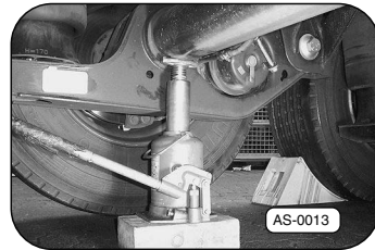
Fig. 14 · Posizionamento del cric
