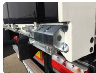
Quad y angular protección
